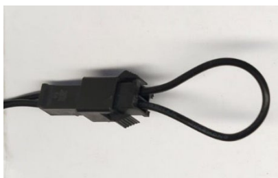
Рис.12 Штекер с перемычкой комнатного термостата
