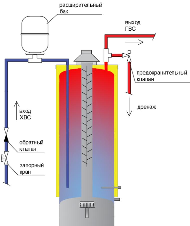
При установке обратного клапана, который используется для предотвращения поступления воды из системы горячего водоснабжения в систему подачи холодной воды, создается закрытая водяная система, в которой создается избыточное давление по мере того, как объем воды будет увеличиваться за счет теплового расширения.
