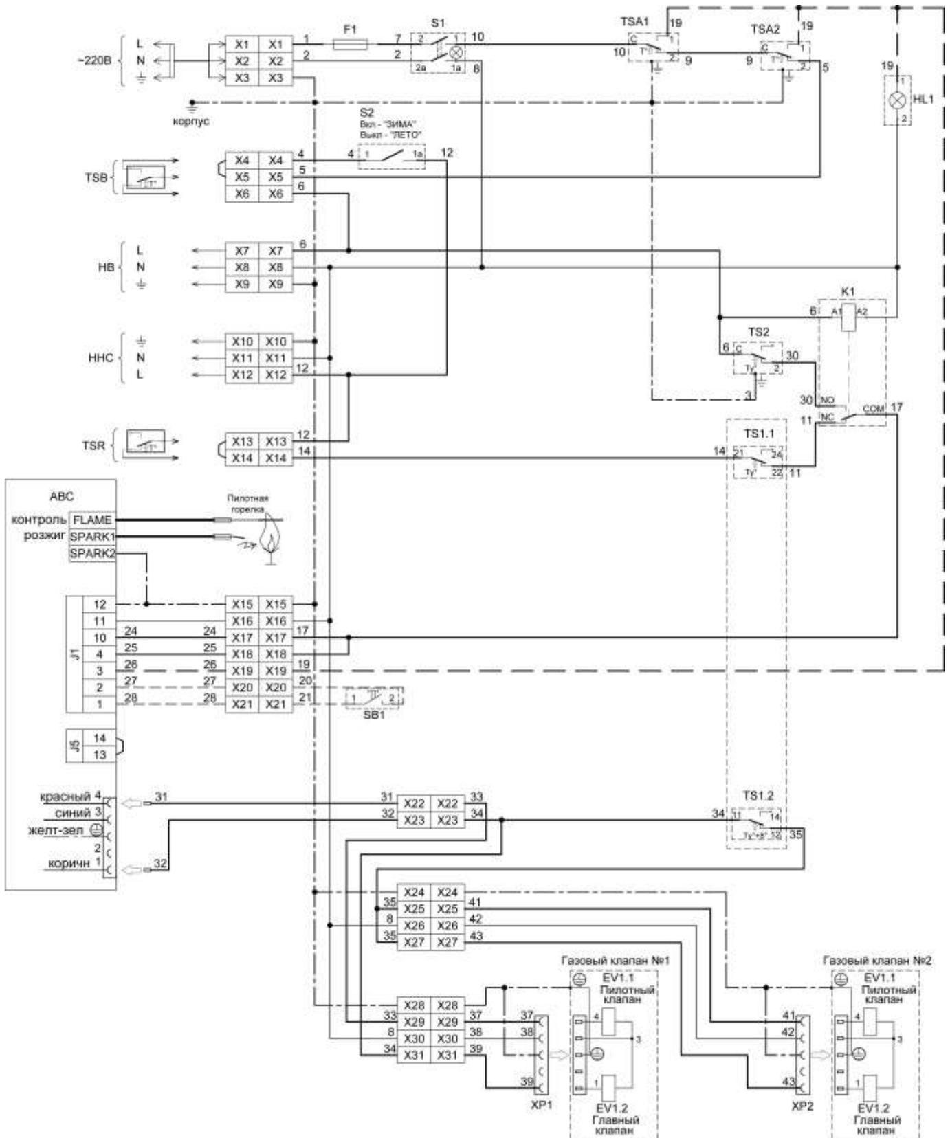
Рисунок 8. Электрическая схема котлов FED Z75E; Z85E; Z95E.
