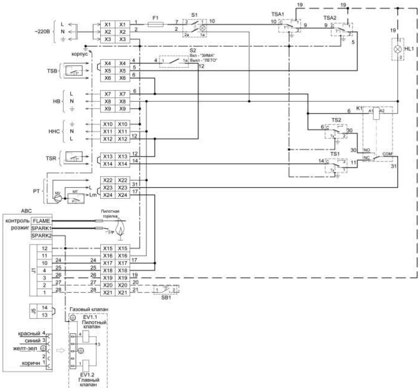
Рисунок 7. Электрическая схема котлов FED Z30E; Z40E; Z50E; Z60E, Z65E.
